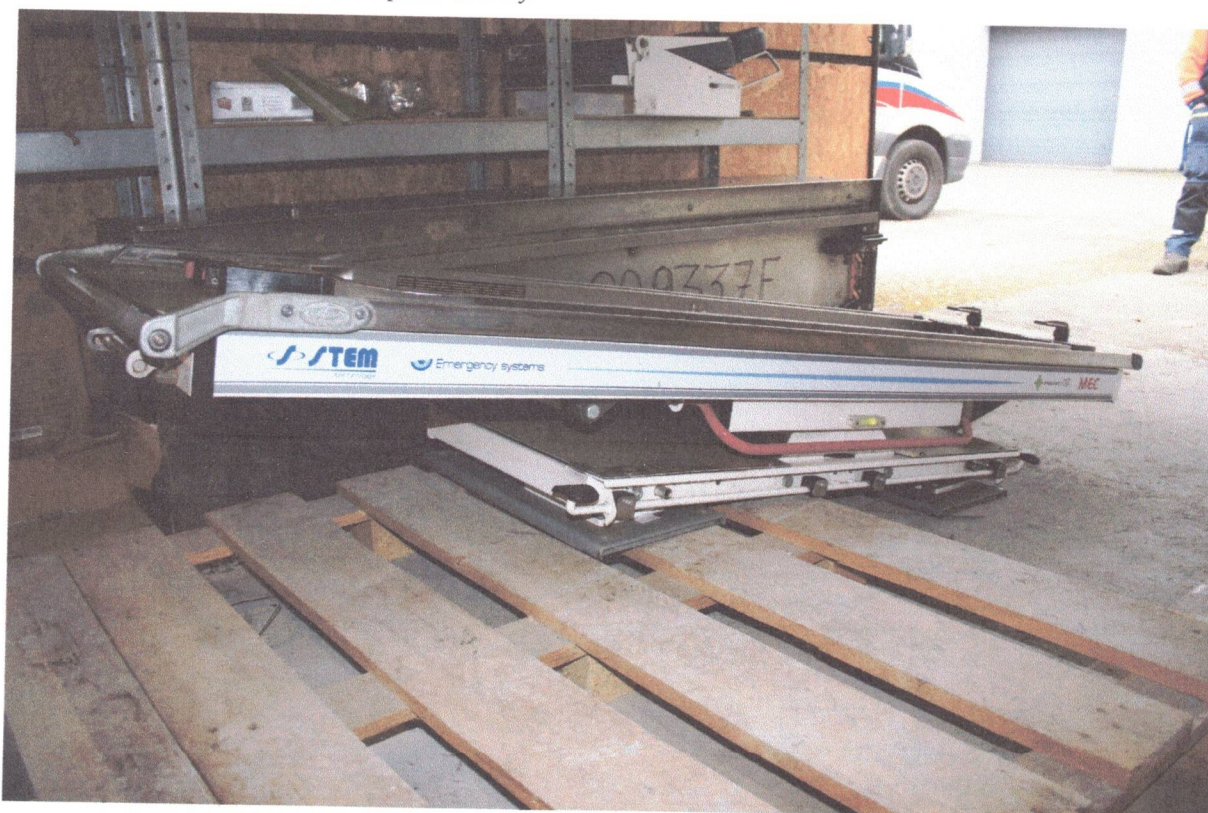
Fot.7 Płyta nośna
